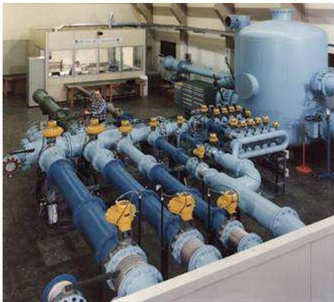
圖 21、PTB 之 gas meter test rig with critical nozzles
