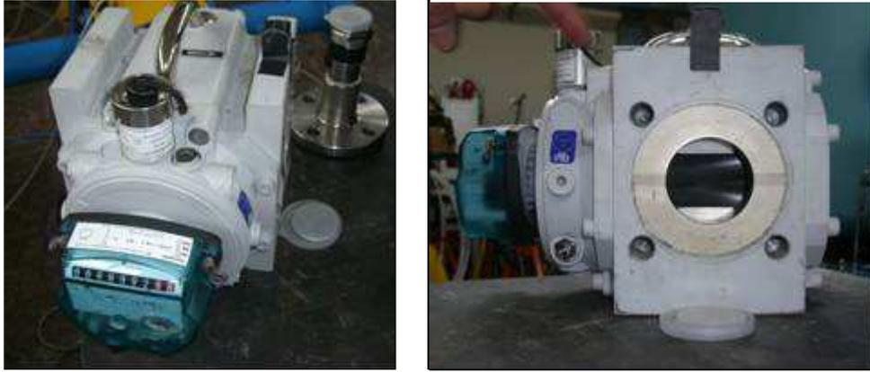
圖 14、轉子式流量計(Rotary Meter)
