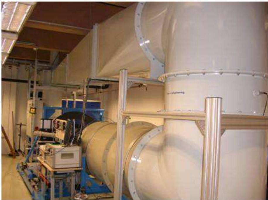
圖 33、PTB 循環式雷射都卜勒風速標準設備
