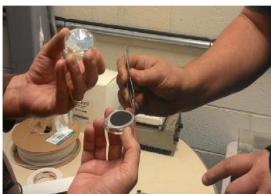
車輛行車型態污染排放檢測－PM樣品收集
