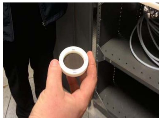
車輛行車型態污染排放檢測－取出PM樣品濾紙
