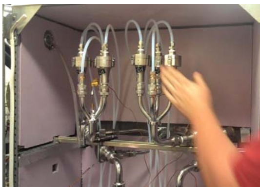
車輛行車型態污染排放檢測－取出PM樣品濾紙
