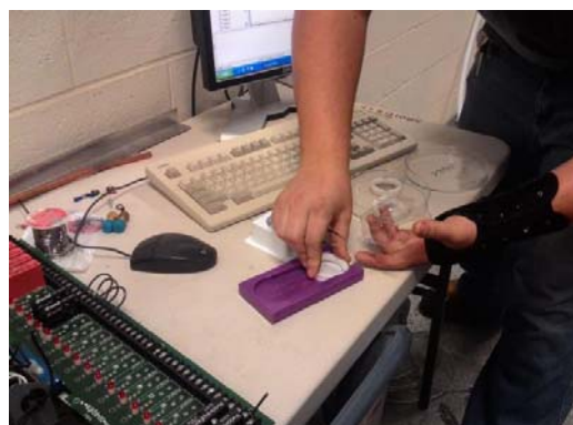
車輛行車型態污染排放檢測－裝填PM樣品濾紙
