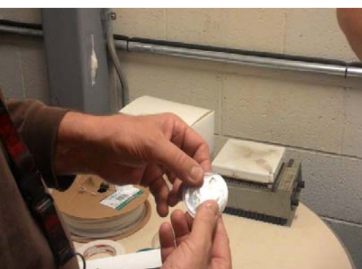
車輛行車型態污染排放檢測－PM樣品收集
