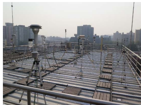
圖 4.3.1-2 北京市環境保護監測中心樓頂空氣微粒採樣器設置情形
