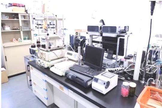
圖 4-6 電線走向皆往上拉之儀器室
