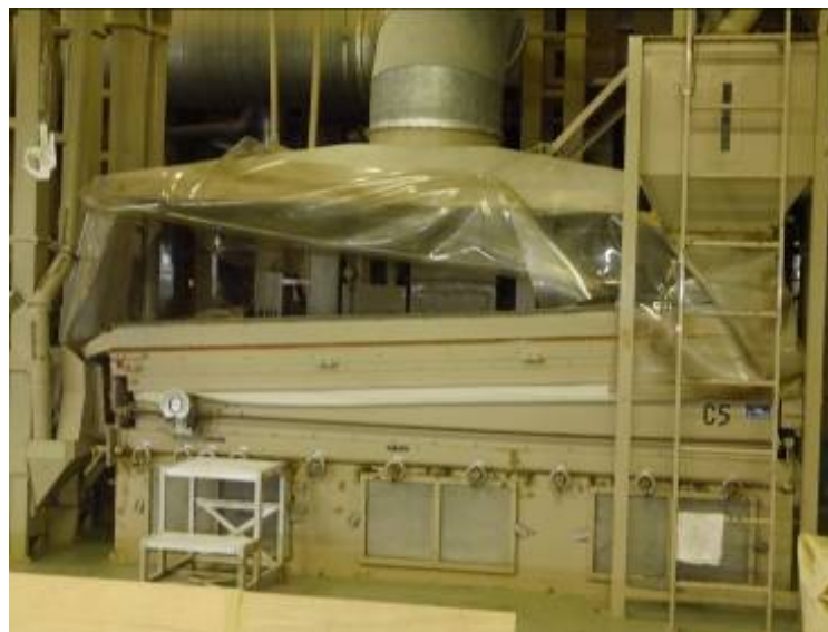
篩選裝置(運用斜度、震動及溝槽，依重量篩選稻穀)
