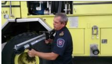
圖 20 消防車上配置泡沫及乾粉二用瞄子
