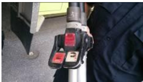
圖 20 消防車上配置泡沫及乾粉二用瞄子
