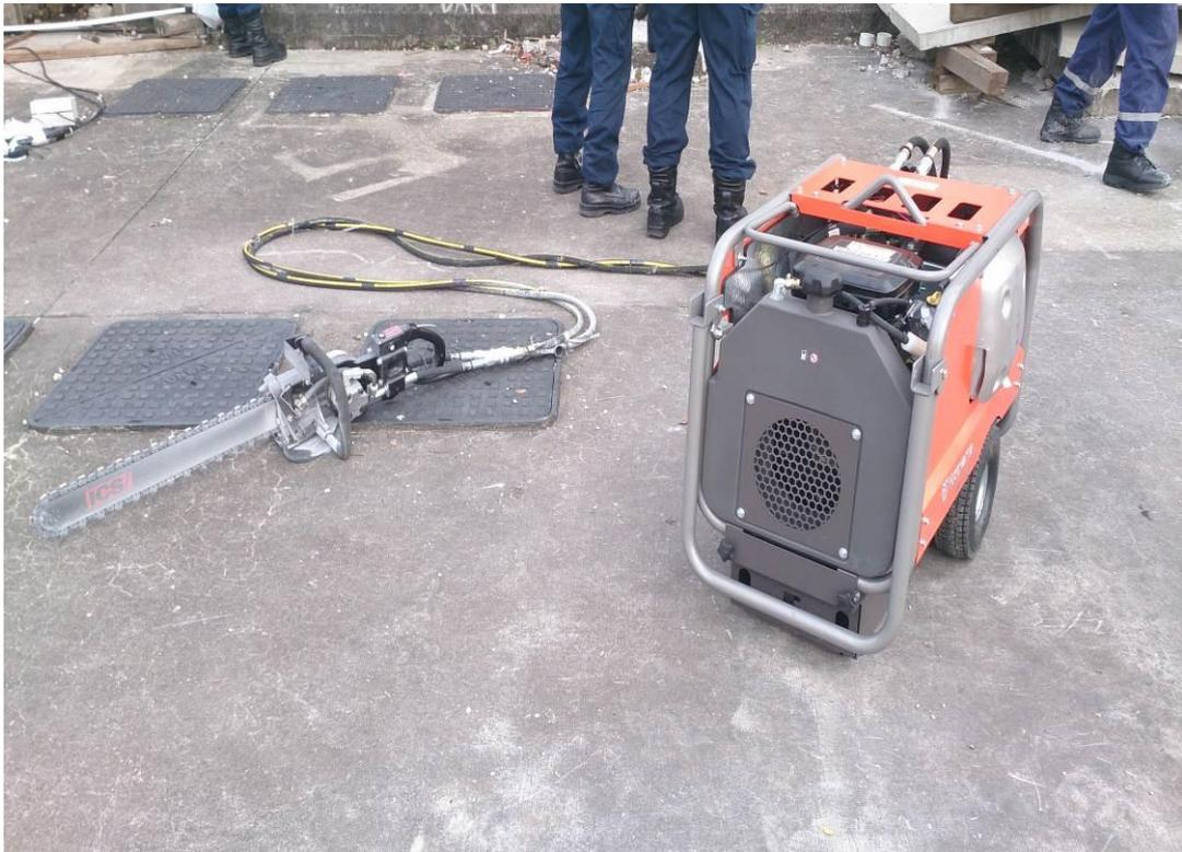
圖 46：低油壓高流量主機及鋼筋混凝土切割鏈鋸。
