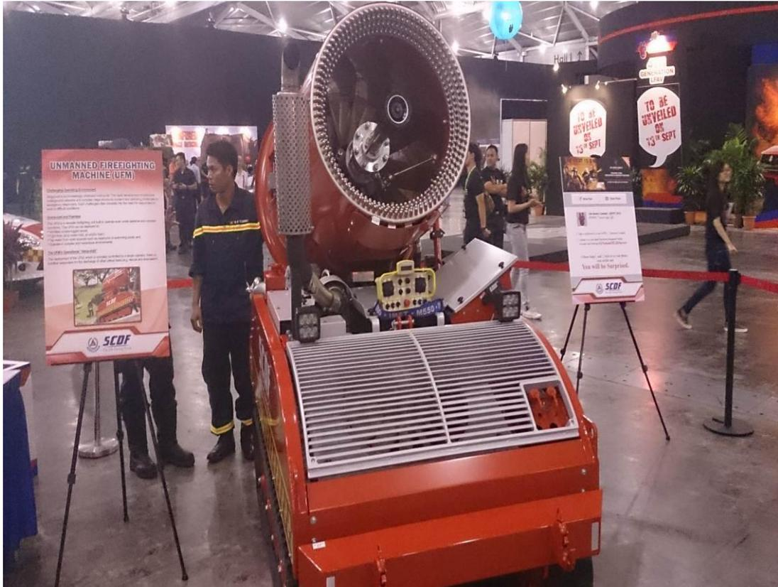
圖 51：先進遙控細水霧及砲塔消防車展示。
