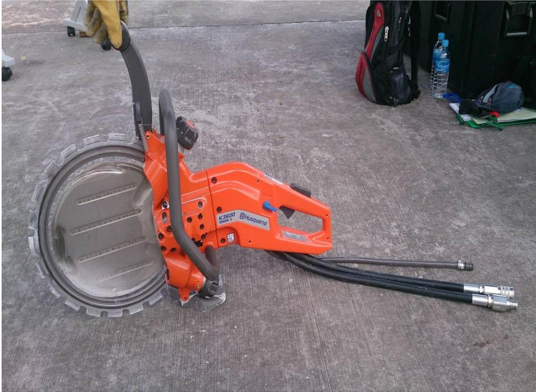
圖 45：新加坡低油壓高流量大型鋼筋混凝土圓盤切割器。
