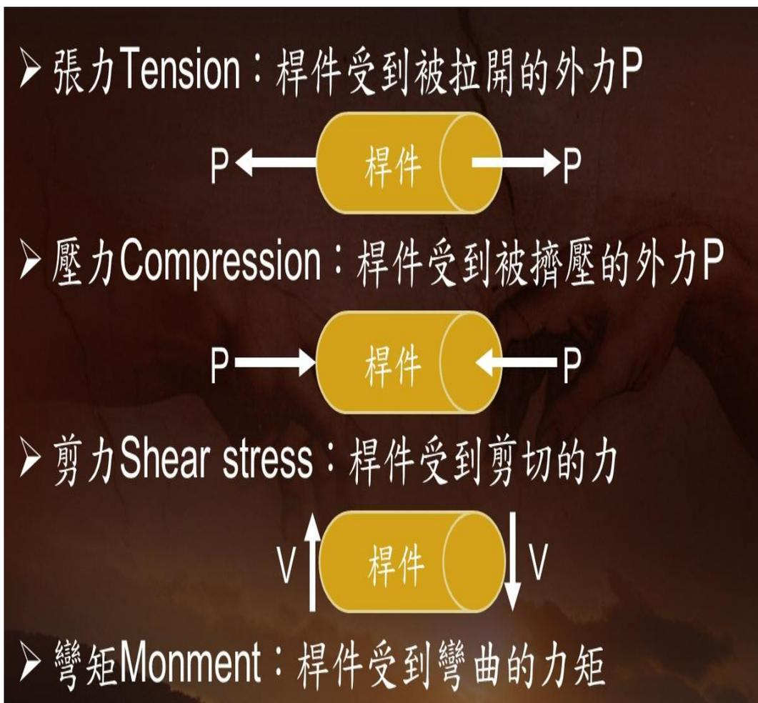
圖 6： 建築結構因質量慣性作用而產生的拉力、壓縮力、剪力與彎矩力。
