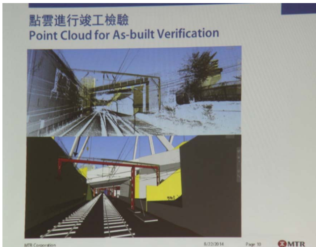
圖 45 港鐵應用 BIM 結合點雲技術於竣工檢驗 (資料來源：參訪簡報)
