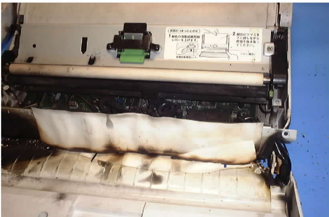
相片 8、在傳真機上之夾紙，已有碳化之情形。
