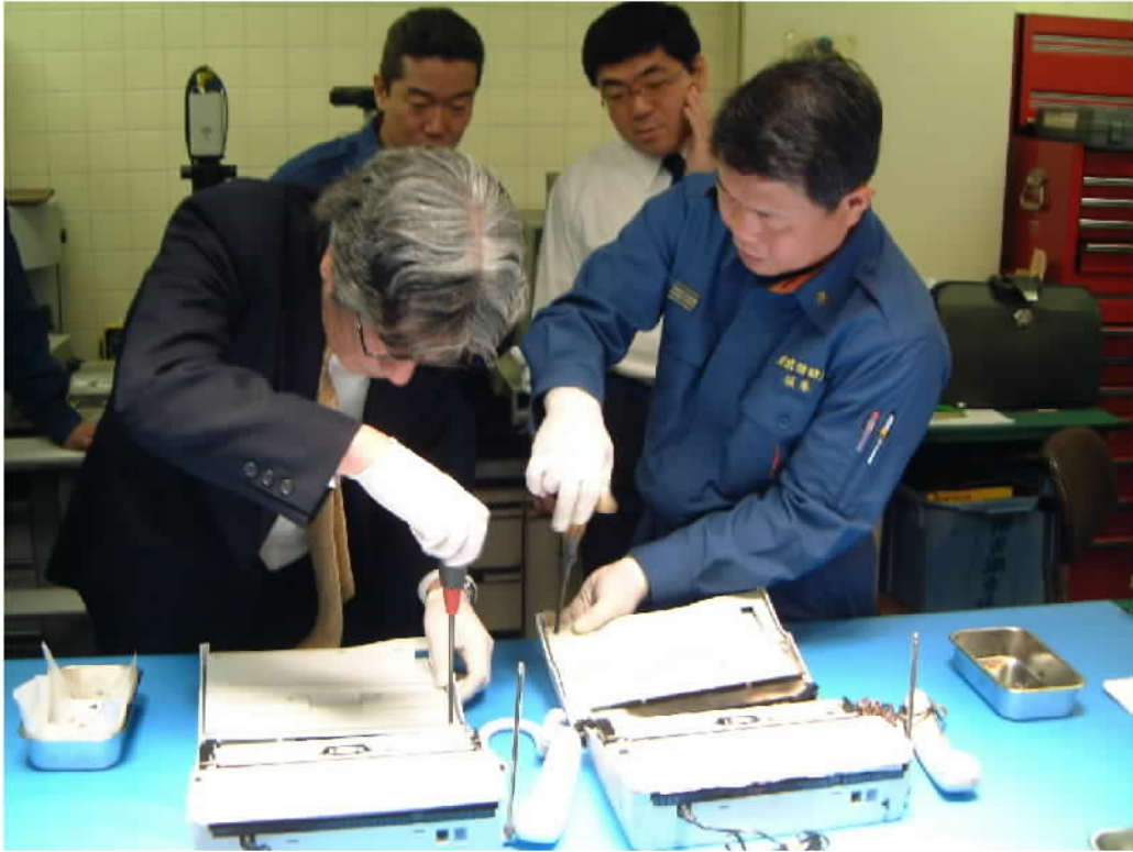
相片 9、火調人員與產品製造商分別拆解產品及火燒之殘骸，進行零件比對。
