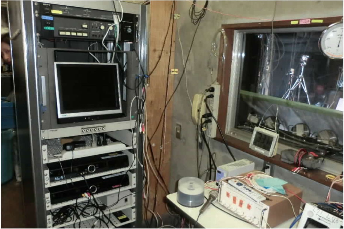
相片 24、模擬燃燒室旁之觀察室，並設有溫度紀錄儀器及監控器材。
