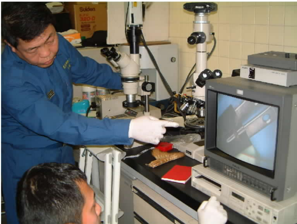
相片 12、火災調查人員以實體顯微鏡檢視插座之痕跡。
