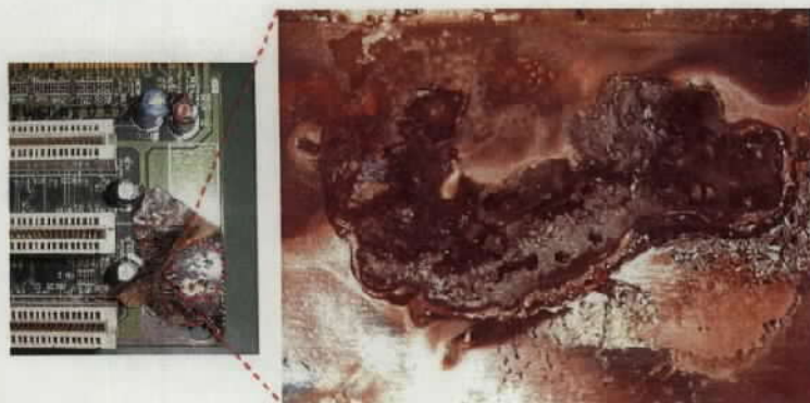
写真2 / 写真3 基板上的異物についてデジタルマイクロスコープを使用して観察した状況
