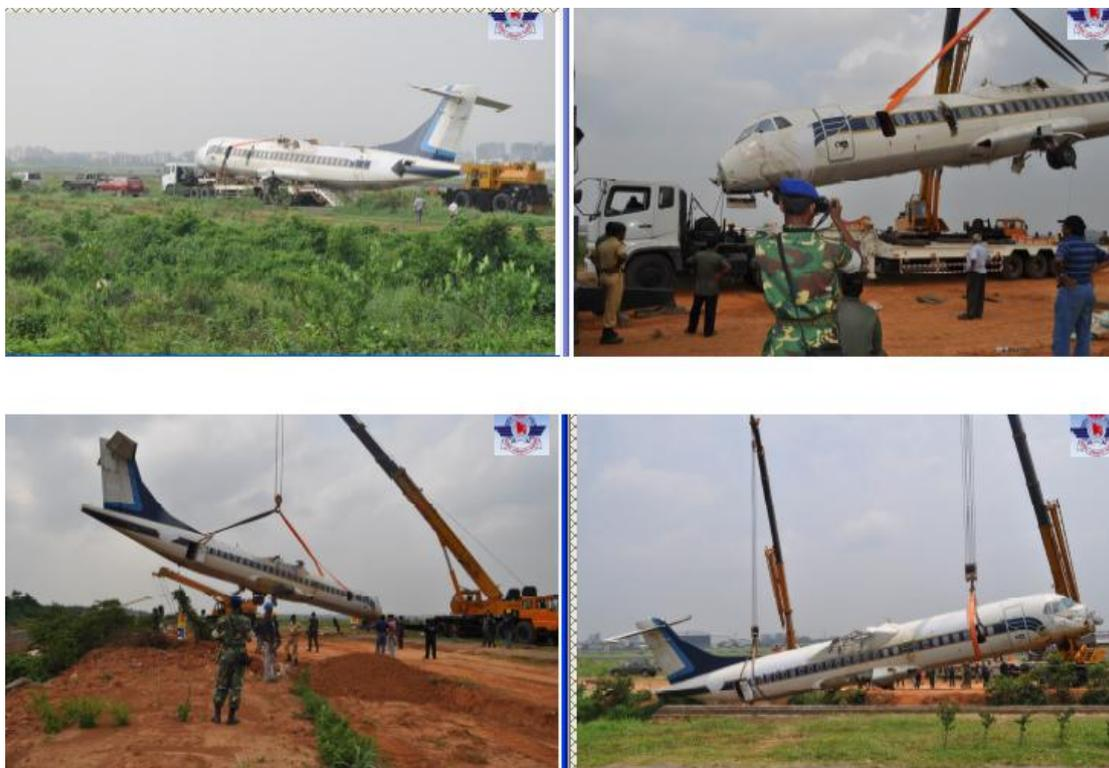
圖 20 孟加拉某一 ATR72-500 型機之殘骸的處置過程
