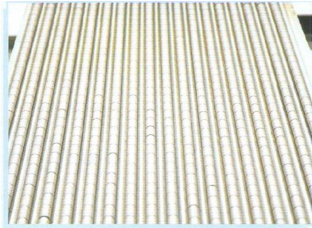
圖 16. 完成檢測的 UO 2 燃料球
