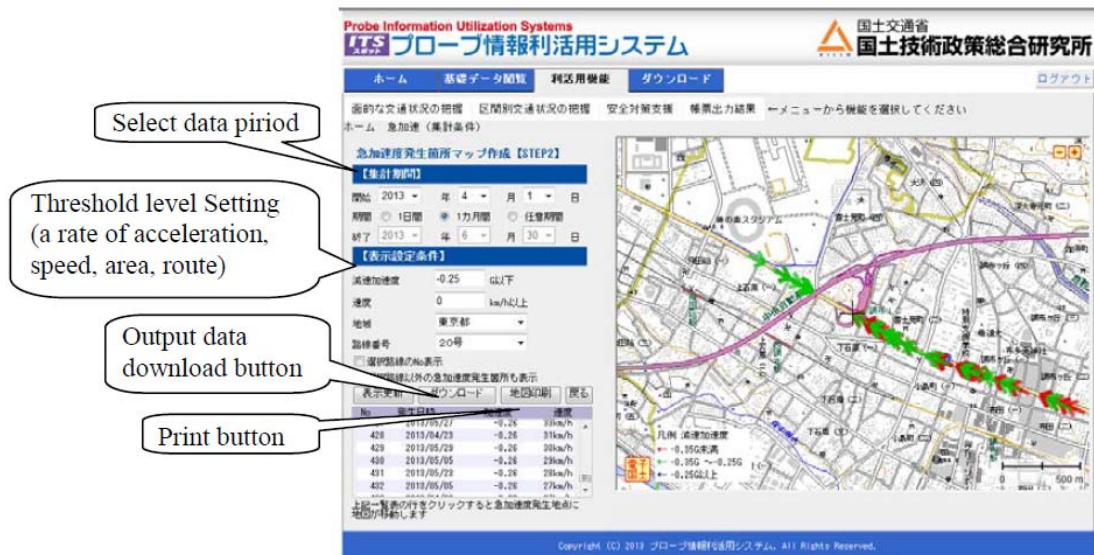
圖 16. 日本「探針資訊運用系統」之車輛突然加速與剎車點位之分析成果
