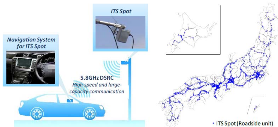
圖 14. 日本 ITS 熱點通訊架構圖及其安裝點位分布
