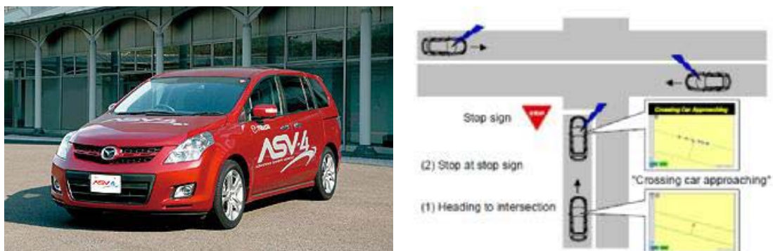
圖 6. Mazda ASV4 號實驗車與所提供路口安全告警功能
