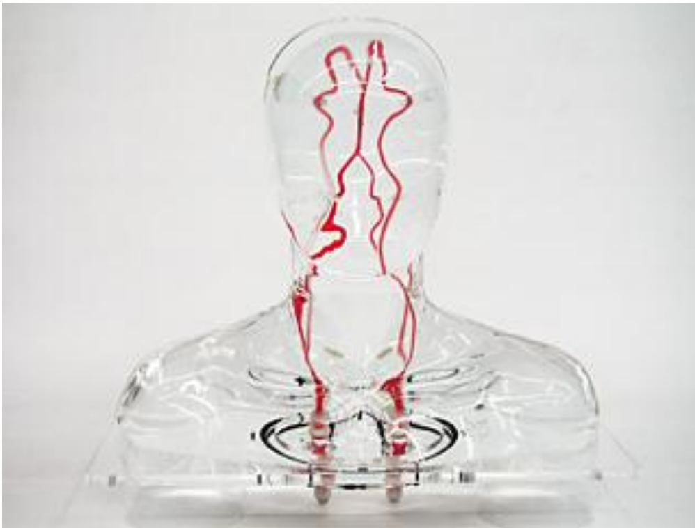
圖七、Fuyo 公司開發的動態血流擬人假體(腦血流)。
