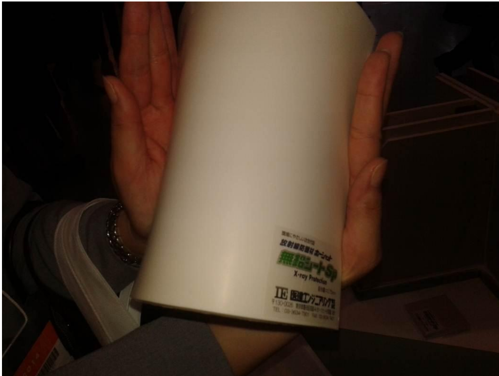
圖十一、無鉛之屏蔽材料 XP 板。
