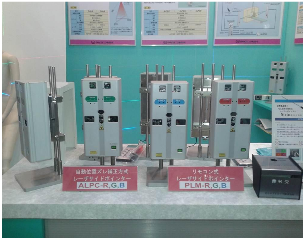
圖十三、TAKEX 公司提供具自動化位置校正之雷射定位裝置。
