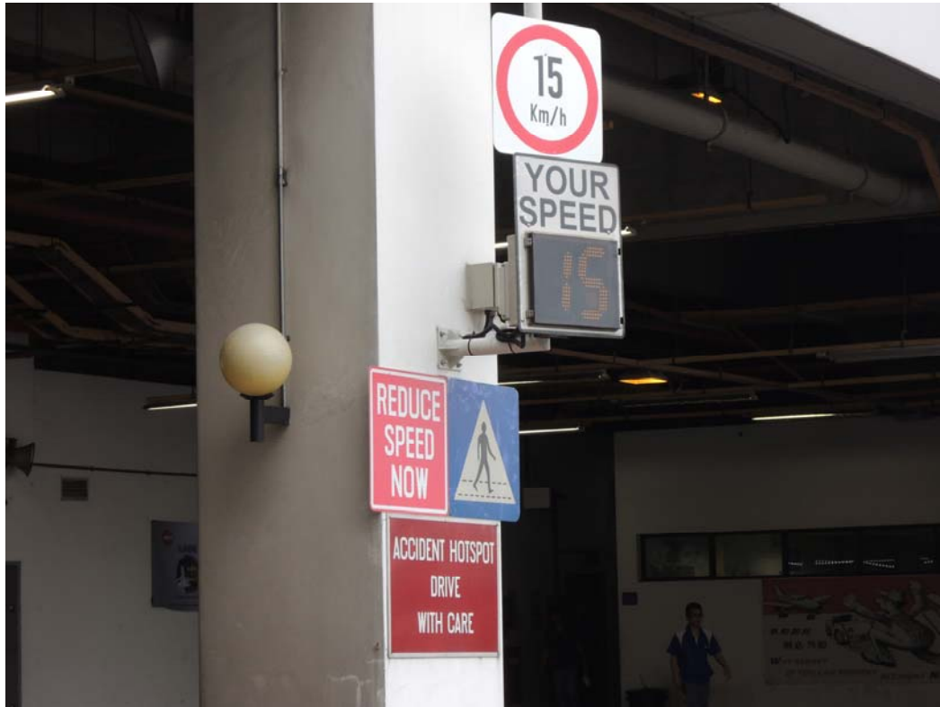
附圖十五：空側機坪車道測速儀器
