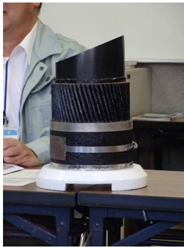
圖 2-7 深層海水鑄鐵製防護管
