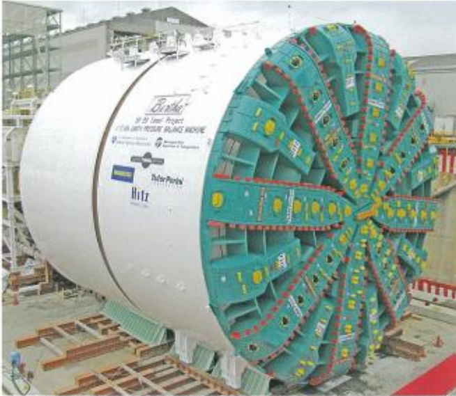
泥土圧式シールド掘進機(世界最大版口径 17.45m) EPB shield tunnel boring machine (The world's largest, \phi 17.45m)
