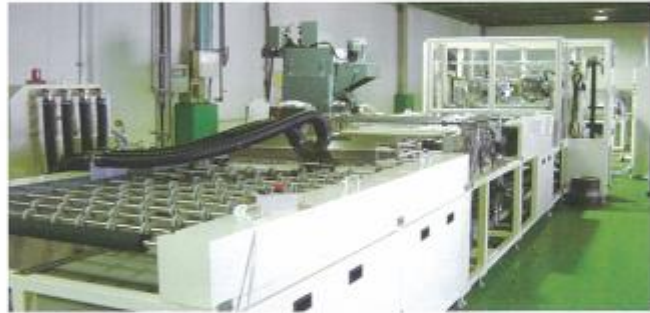
板材循环再利用系统(金属薄膜去除装置、ITO剥离机)
