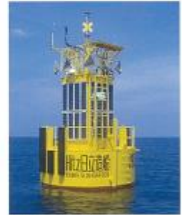
GPS 総合海洋観測システム GPS comprehensive oceanographic monitoring System
