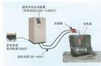
放电冲击破坏施工方法系统
