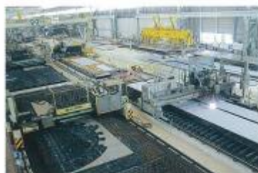
①NC切断機、NC高速ガーダボール盤 NC cutting machines, High-speed NC girder radial drilling machines
