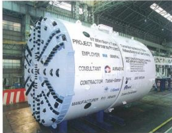
用于横贯博斯普鲁斯海峡铁路建设的盾构机
