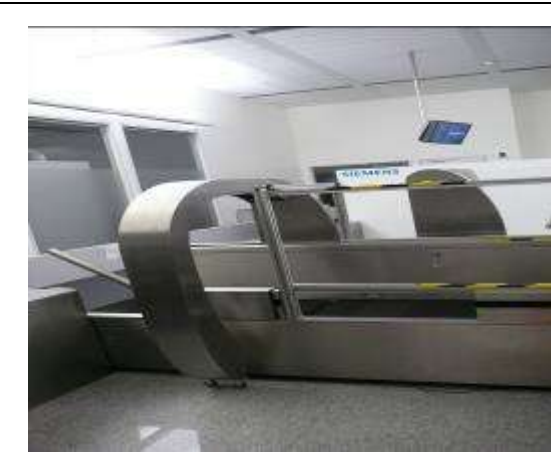
整合 SICK 公司 barcode scanner 行李辨識系統
