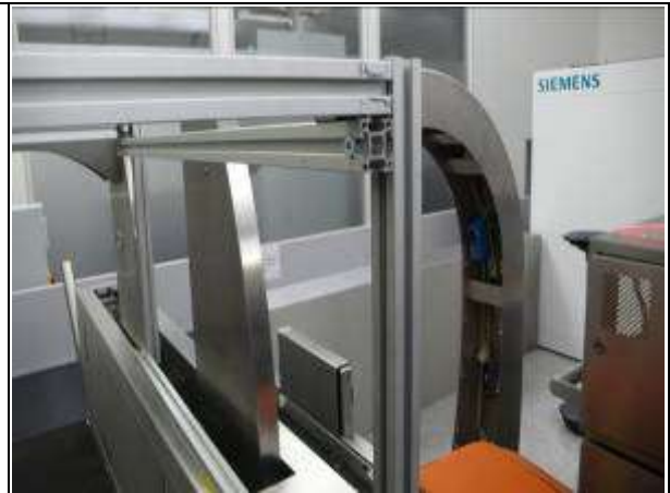
整合 SICK 公司 barcode scanner 行李辨識系統
