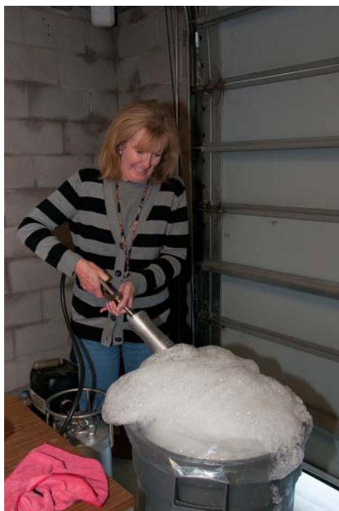
圖十二、延遲裝置（Aqueous Foam泡沫）展示
