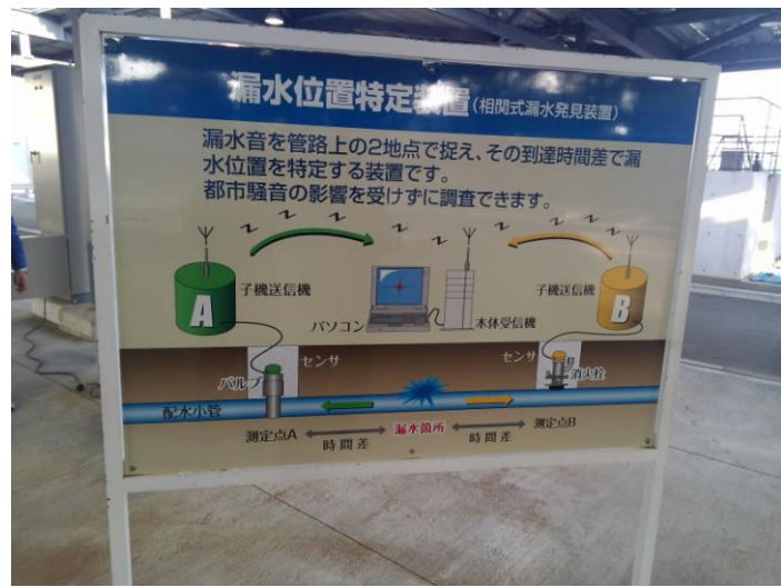
圖 53:漏水位置特定装置場地
