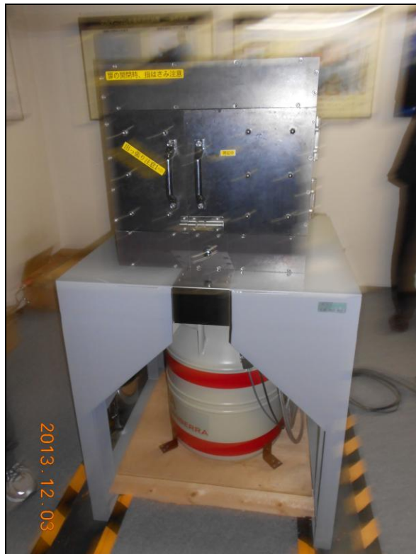
圖 34.水道局水質中心檢驗水中輻射物質之儀器
