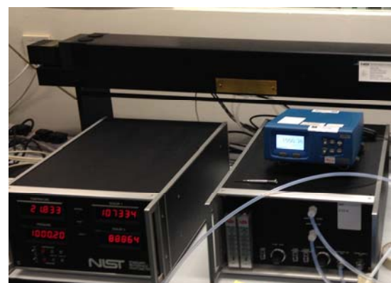
圖 3. 攝於新加坡科技研究局(A*STAR)國家計量中心(NMC)，左一為研究員劉匯，右一為量測實驗室主任蔡福安。右圖為臭氧一級標準光度計，提供臭氧傳輸標準比對使用。
