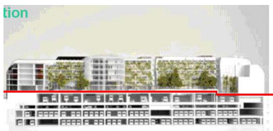
屋頂為消防避難空間
