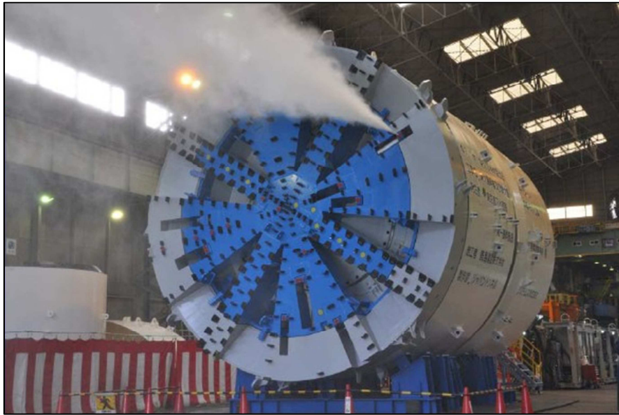
圖 14、DO-Jet 高壓噴射狀況
