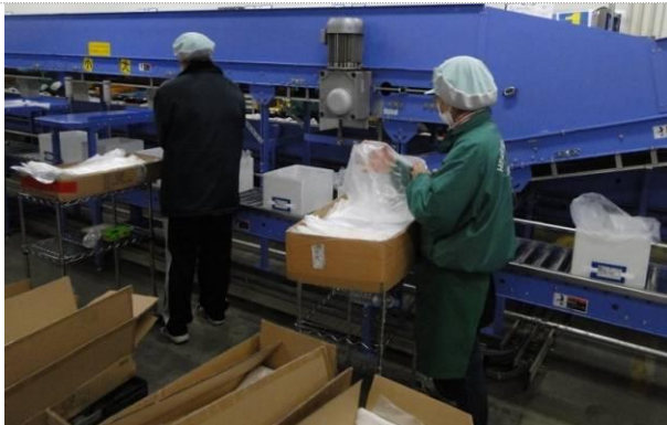
冷凍冷藏食品先將塑膠袋套上塑膠物流管，用輸送帶把物流管送至揀貨區
