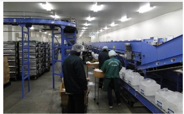
冷凍冷藏食品先將塑膠袋套上塑膠物流管，用輸送帶把物流管送至揀貨區
