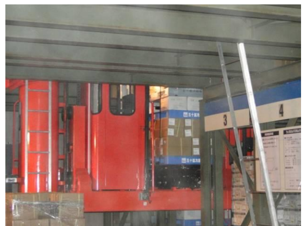
進貨時，自動存取機將貨物棧板送至資訊系統指定位址
