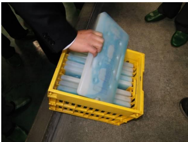
利用蓄冷庫將蓄冷棒儲存至一定溫度，放入已揀貨運輸物流箱中保持低溫
