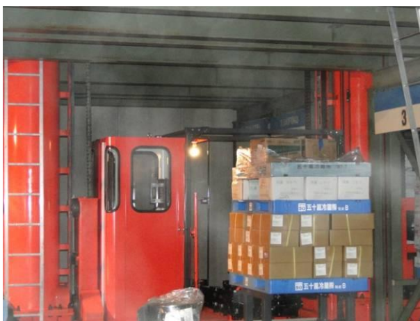
進貨時，自動存取機將貨物棧板送至資訊系統指定位址
