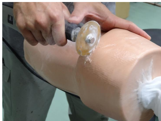
塑酯灌漿硬化後將義肢承筒切開
