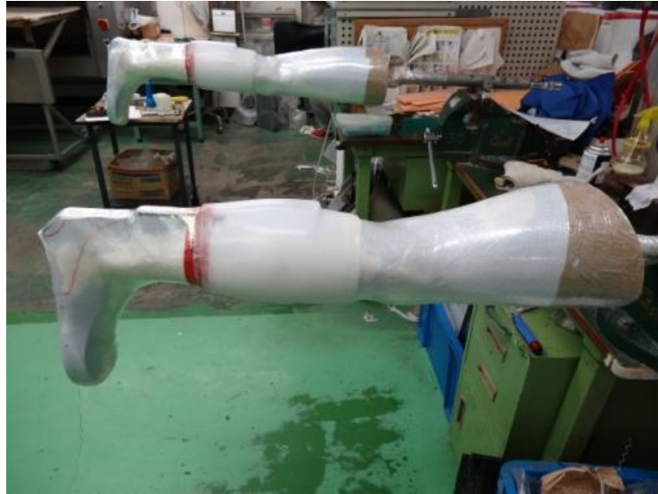
下肢模型塑膠成型—小腿區局部成型技術
