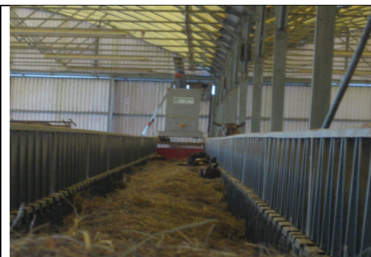
圖 5. 軌道式精料機(中)及粗料輸送帶。
