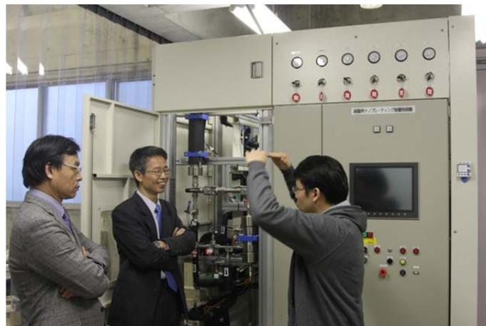
圖 6 曾根教授研發之超臨界二氧化碳乳化電鍍之製程設備工業用試量產版
