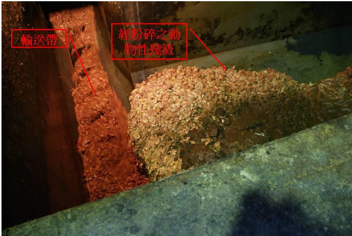
圖 10，攪碎後之原料與卸料槽之原料混合後由螺旋輸送機送至加工區。
