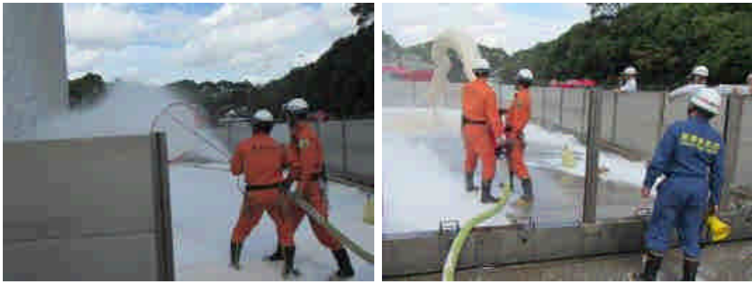
圖 55：操作手持式泡沫發射器進行泡沫噴射。
