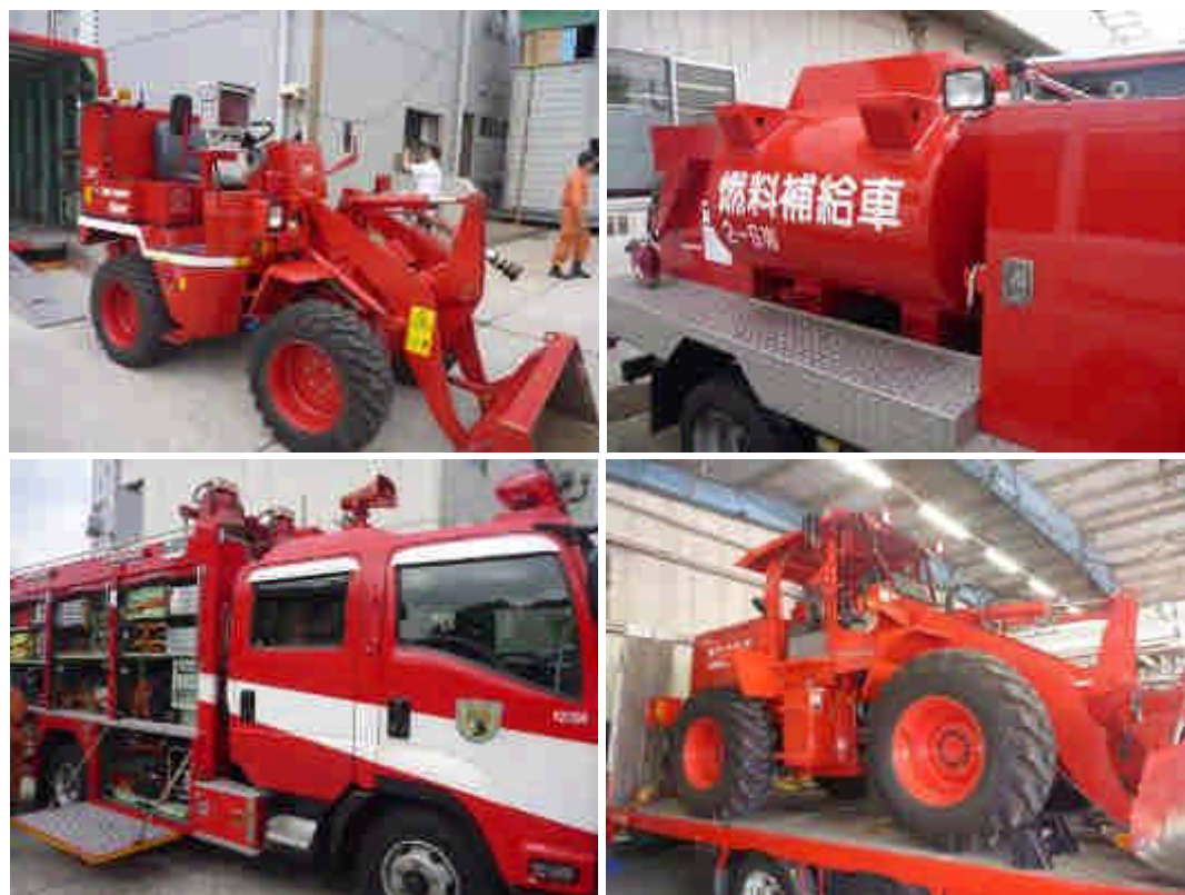
圖 24：救助機動部隊各式特種車輛。左上為清運土石車輛（小山貓）、右上為燃料補給車、左下為救助器材車輛、右下為載運小山貓之車輛。
