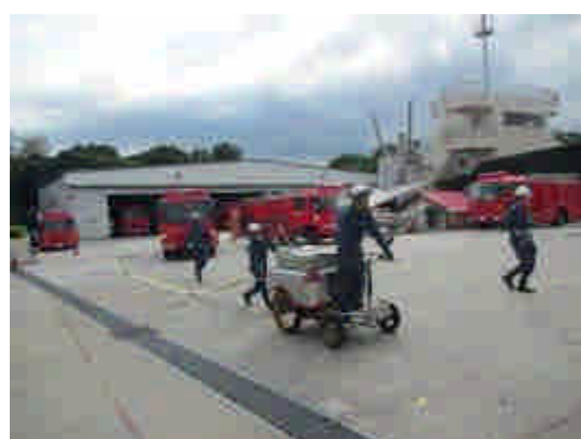
圖 92：以水帶運輸車進行水帶部署情形。
