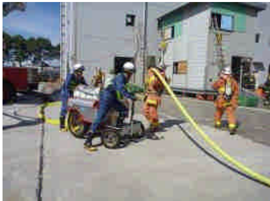
圖 47：使用水帶運輸車來加速水帶部署效率。
