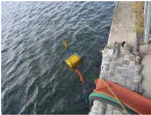
圖 74：以沈水馬達沈入海中取水。
