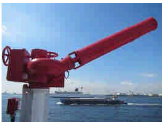
圖 84：船艇所配置之消防滅火砲塔。
