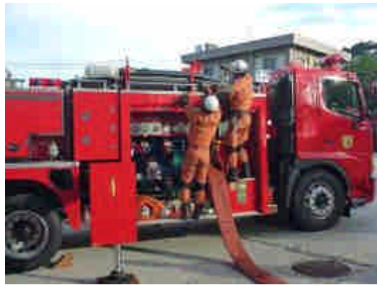
圖 75：以連結送水車進行遠距離送水。
