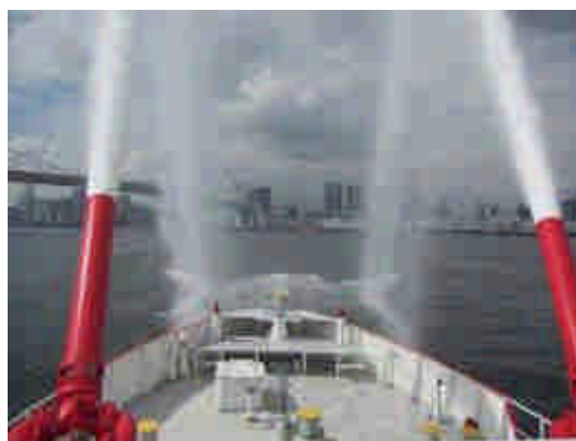
圖 85：砲塔同時射水情形。
