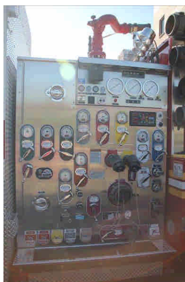
圖 6-9 超高壓消防車操作面板
