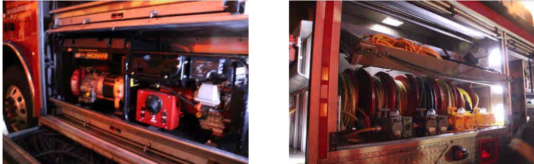
圖 6-10 高層火災處理車左右面裝備箱
