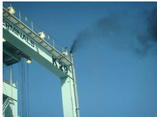
圖 4-15 膠輪式龍門式起重機由於仍是採用柴油機動力，在運作時依舊能見到黑煙排放。
