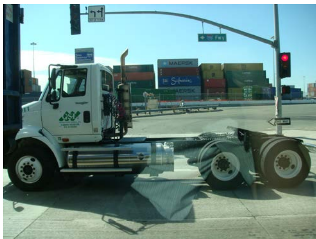
圖 4-16 港區內使用 LNG 之重型貨車
