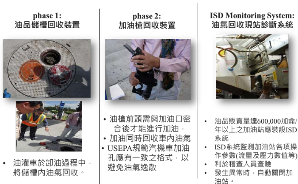
圖 4-8 加油站油氣回收設施實地參訪
