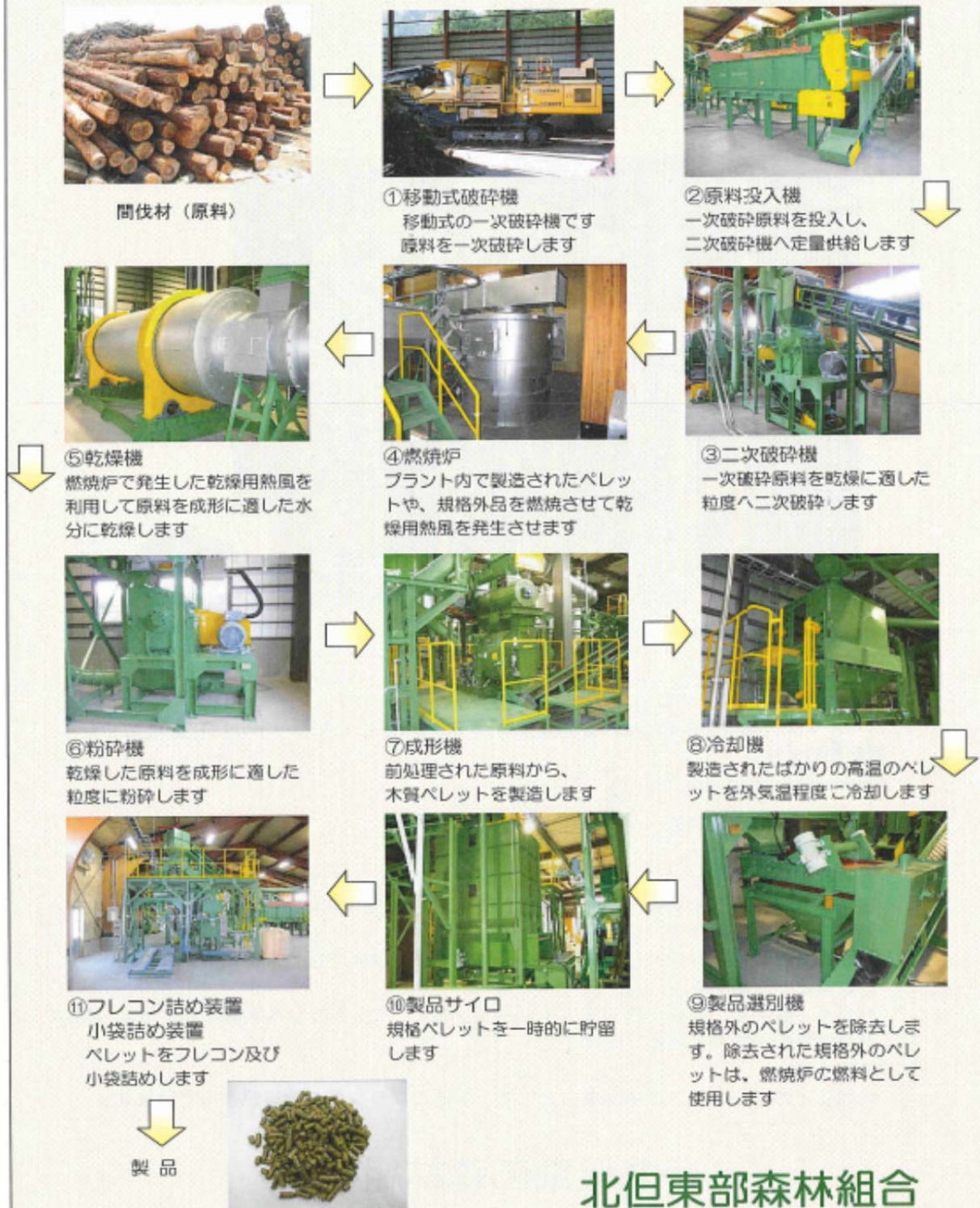
圖 10 木材生質能製作流程圖
