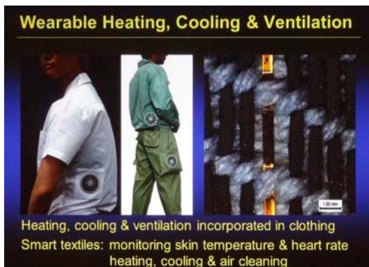
圖 17 穿戴式個人空調系統說明
