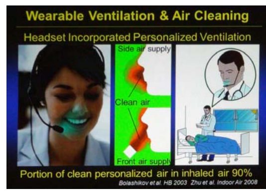
圖 16 頭戴式個人空調系統說明
