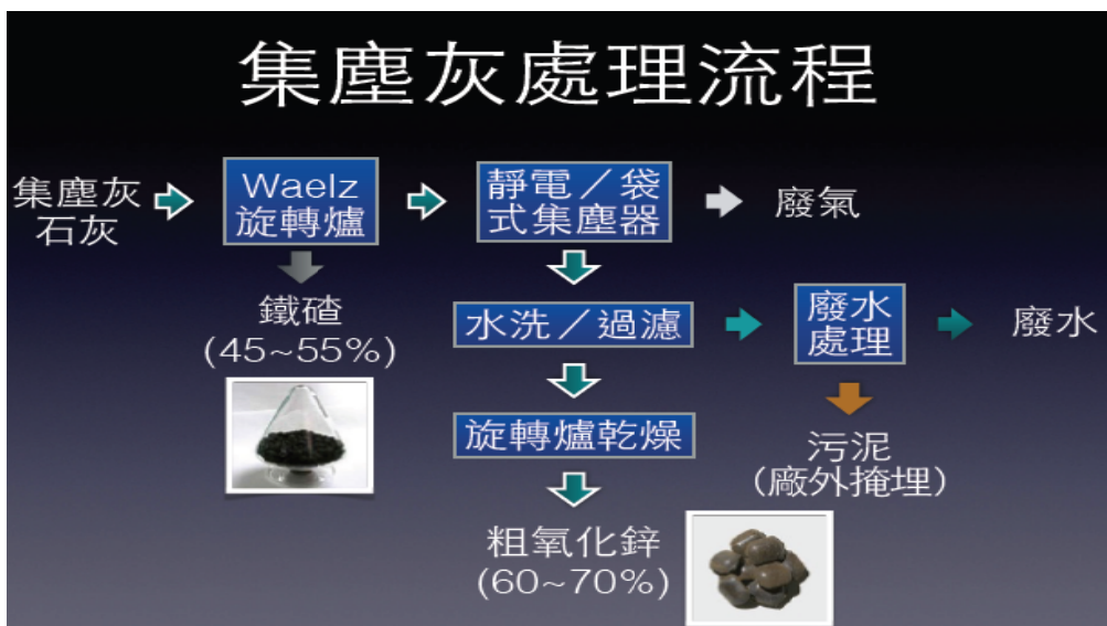
圖 2.4 四阪製錬所電弧爐煉鋼集塵灰處理流程
