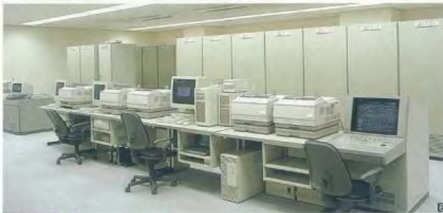
電算機室 工場内のいろいろな機器の監視、操作に関する情報の収集および処理をここで行ないます。
