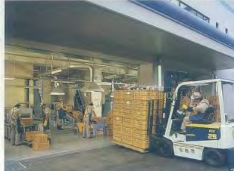
資源化センター 資源ごみ(空き缶・空きビン)を、生ビン、スチール缶、アルミ缶、カレット等に選別し、再利用、再資源化を図ります。
