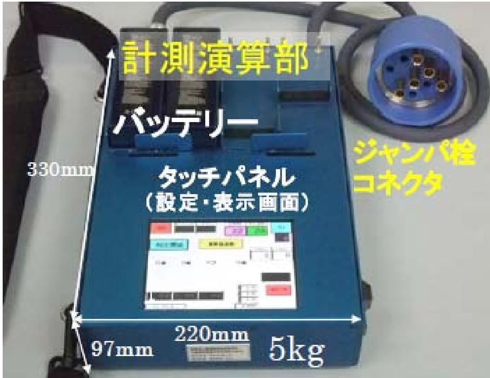
圖 2-17 本研究開發之可攜式斷線部位識別裝置
