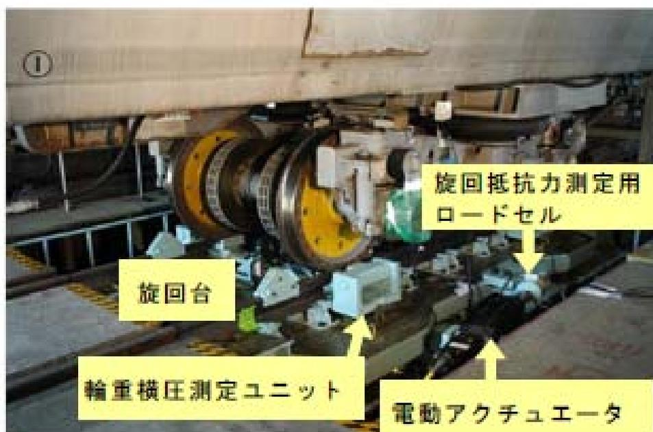
圖 2-14 轉向架轉彎性能試驗裝置構造
