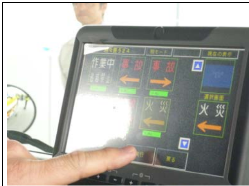
標誌車控制平板電腦
