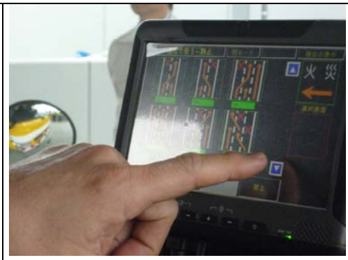
標誌車控制平板電腦
