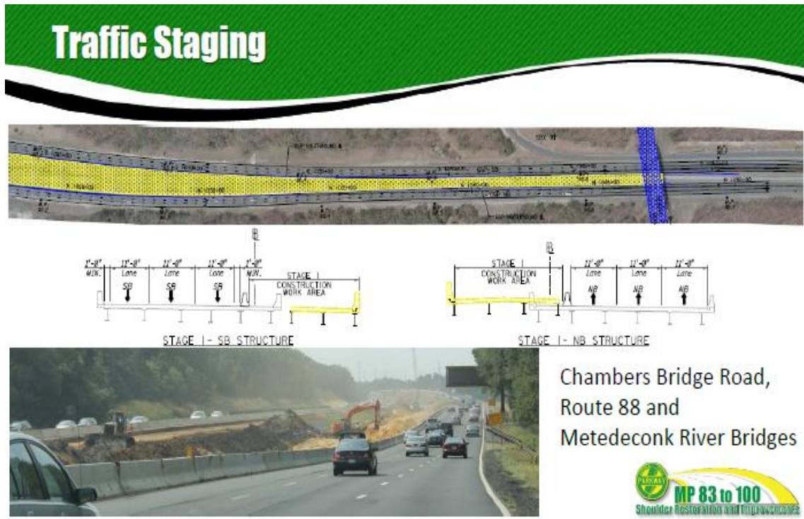
圖 47. 經過 Chambers Bridge Road, Route 88 和 Metedeconk River Bridges 的施工挑戰 (第一階段)
