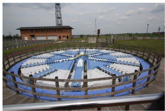
照片 3-12 說明：施工使用之鑽掘機鑽頭，功成身退後，保留 利用(時鐘裝置)，兼附教育意義。
