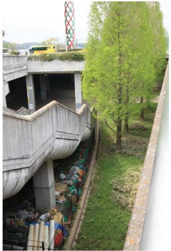
照片 2-06 說明：館場結構主體下方遮陰顯著、日照不足之處，仍植樹綠化，栽植樹種並選取長成高度高之大喬木。
