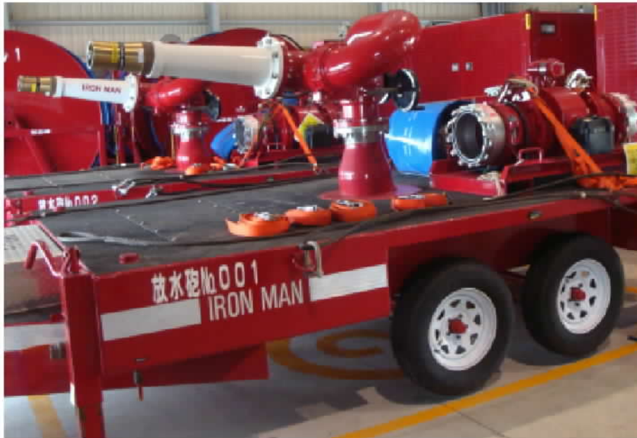
圖 5-3、大容量泡沫放水砲（右側）
