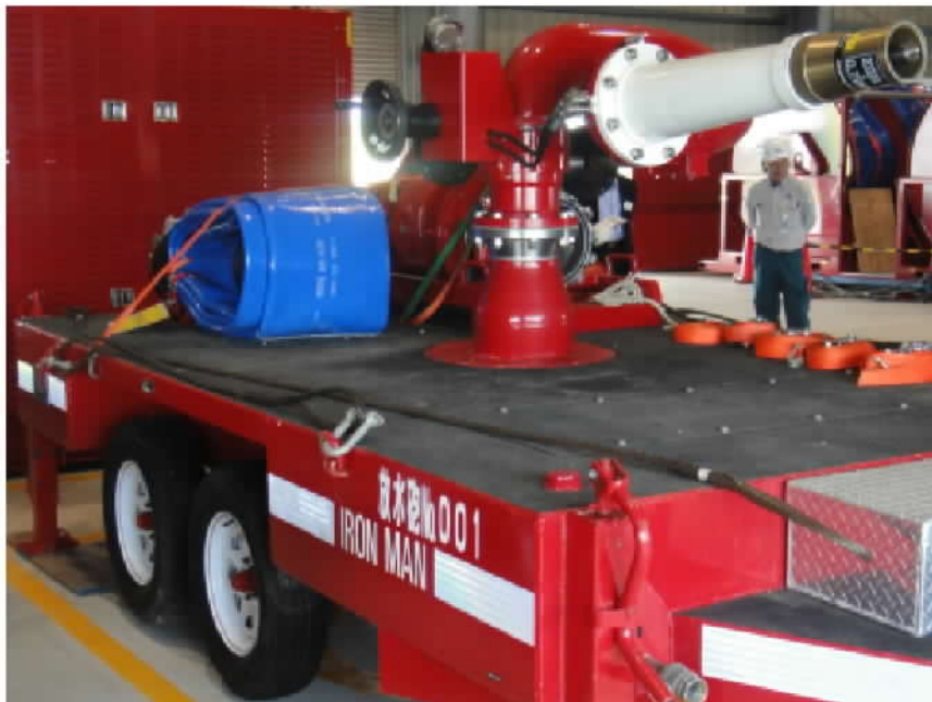
圖 5-5、大容量泡沫放水砲（左側）
