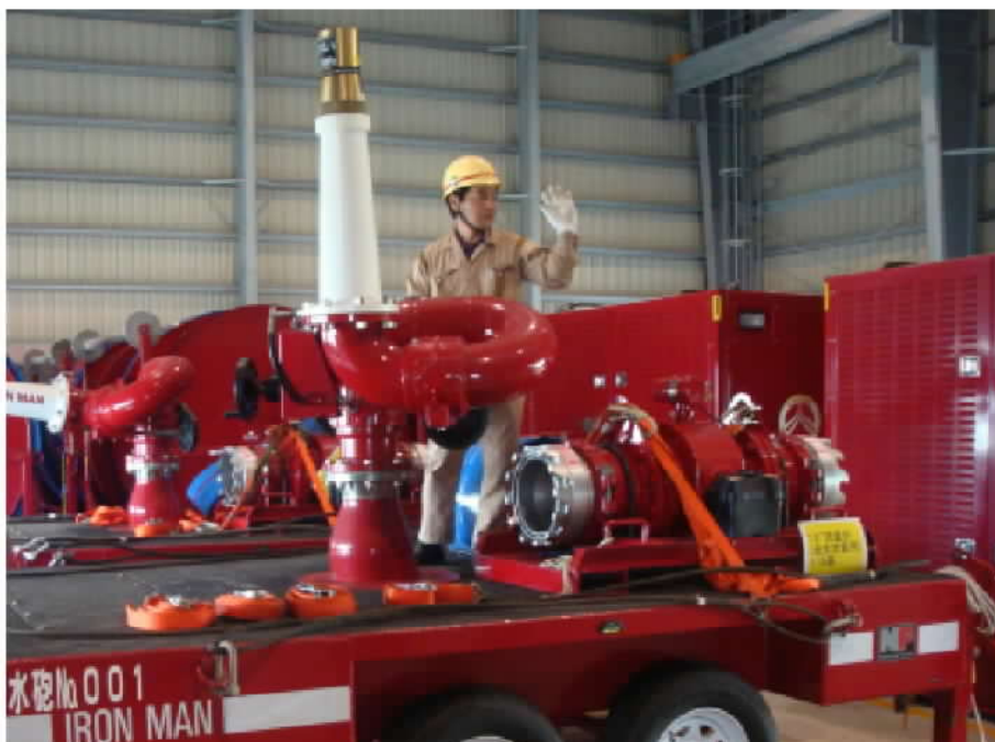
圖 5-6、大容量泡沫放水砲（垂直角度）
