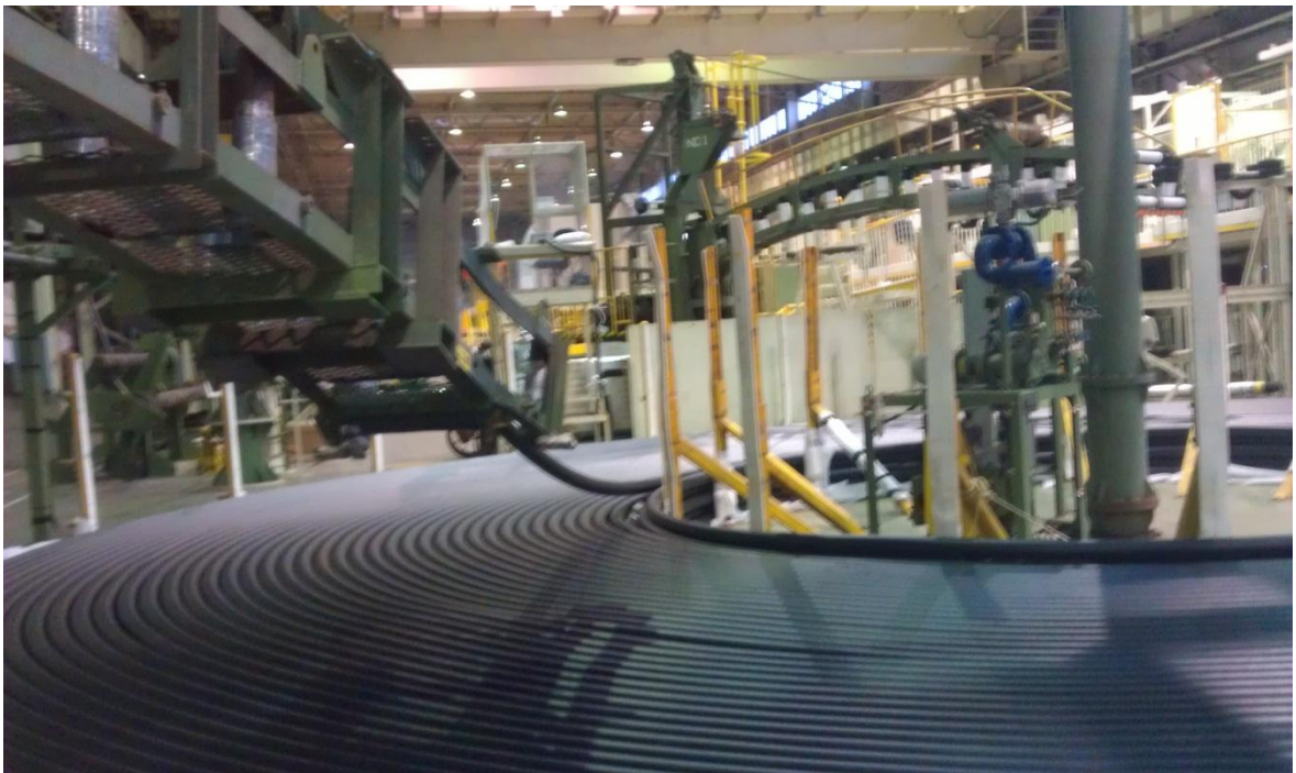
照片 14:第一條海纜接續完成後之繃紮帶繞捲製程之轉盤引取情形
