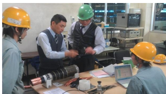
照片 7 海纜構造尺寸檢測
