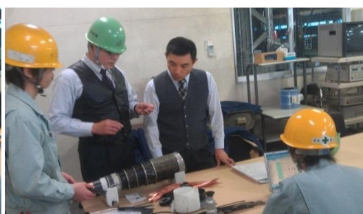
照片 8:海纜構造尺寸檢測
