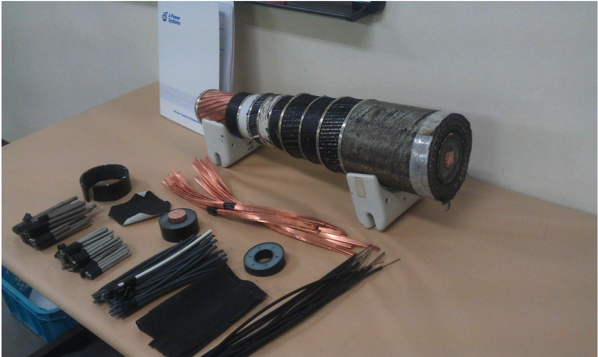
照片 11:解剖海纜結構及各層材料之種類及數量
