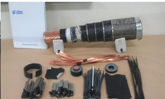
照片 2:海纜成品結構及解剖後各層材料
