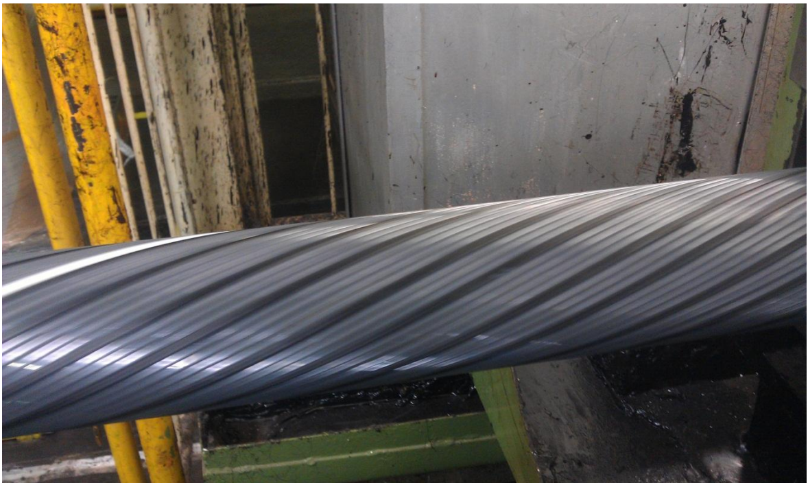
照片 12:海纜光纖之繞捲生產製程 (黑色為 12 芯之光纜、灰色為分隔線、白色為製程之辨識基準線)
