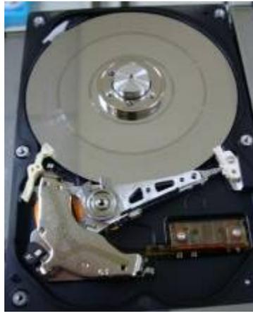
圖 3.1.4 硬碟磁盤刮盤
