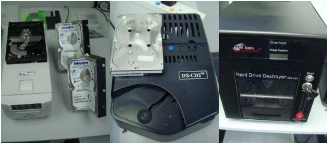
圖 2.1 硬碟消磁機、硬碟破壞器
