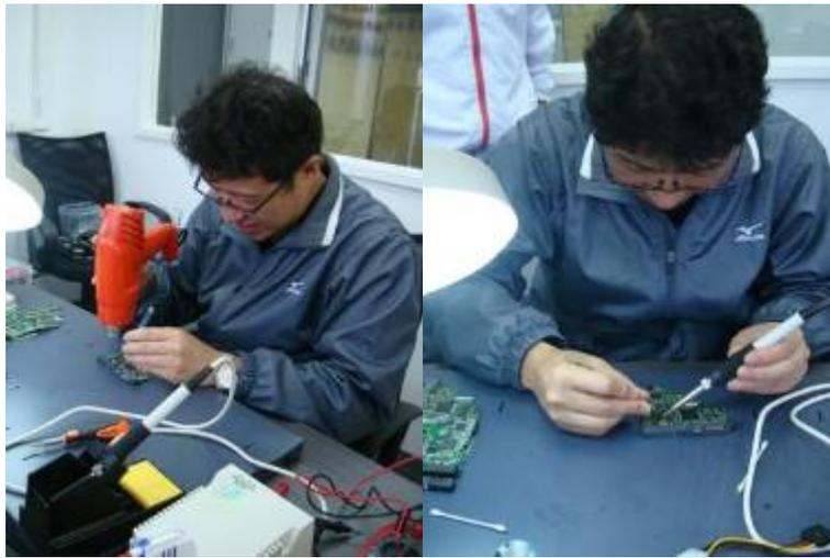
圖 3.3.14 使用熱風槍取下 EEPROM 後再焊回去
