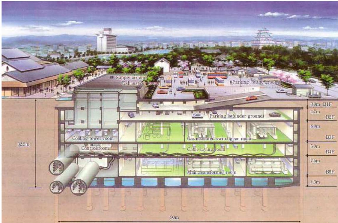
圖 7 名城變電所配置示意圖 (資料來源：中部電力公司)
