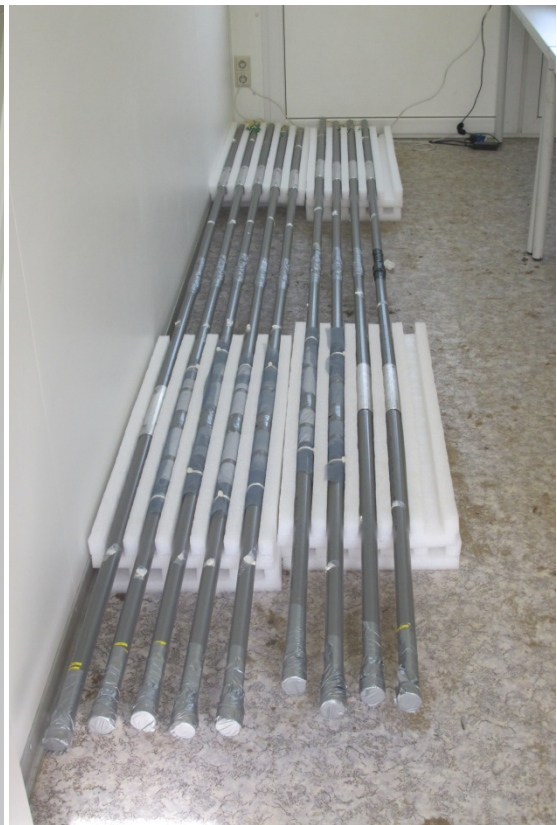
圖 7 South dike 9 組 4 米感測器組裝完成
