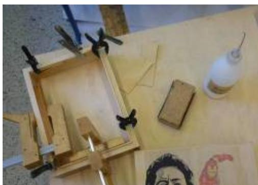
先使用圓盤鋸切好需要用的木板，再使用膠黏合，最後以夾具固定。
