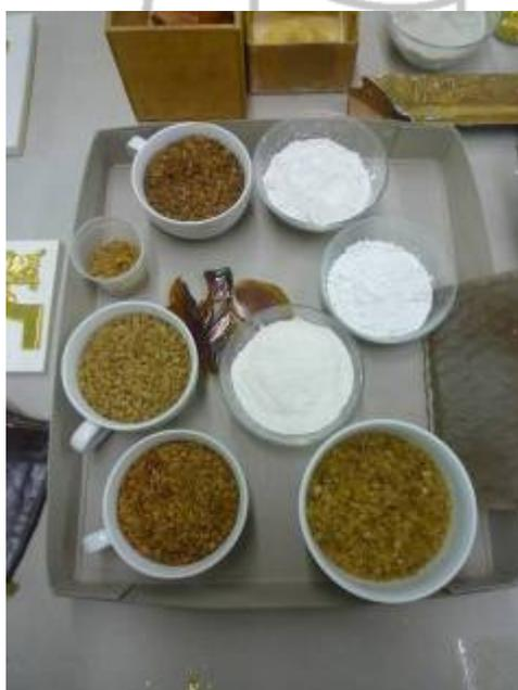
圖 49. 水性貼金常用的材料(動物膠、碳酸鈣)
