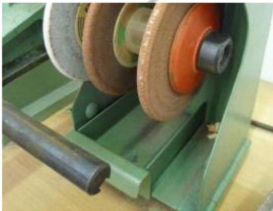
圖 85. 自磨刀機取出的鐵粉碎屑
