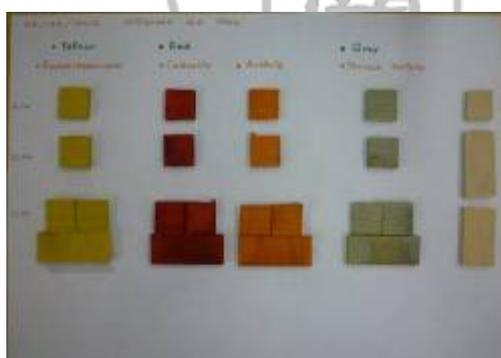
在將完成後的木片染色前，建議先進行染料的測試，以掌握符合自己期待的顏色，即便是同樣的染料應用於同樣的木頭，在製備與染著的過程中，也會因不同的溫度、時間和濃度等因素，產生顏色深淺不同的結果。
