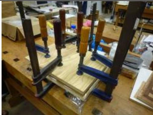
塗刷骨膠速度必須要快，若作品背面與欲黏合的木板之間有些許空隙(鑲進去的木板與背景木板厚度有些許落差)，可使用紙纖維粉+膠作為填料來填補落差。膠合後，上面再放置一平整木板，中間隔著紙和聚酯片，最後使用夾具固定。
