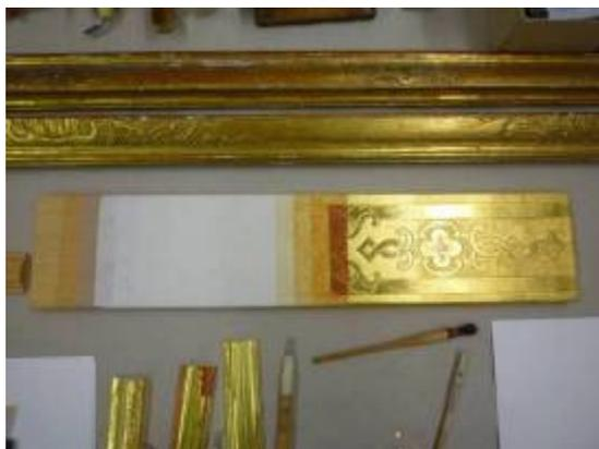
圖 51. 水性貼金製作工序
