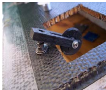
導輪的斷裂，前輪碳纖脫落，導輪螺絲彎成 30 度
