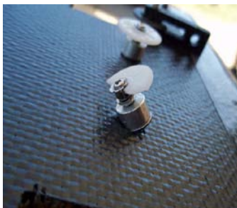
導輪的斷裂，前輪碳纖脫落，導輪螺絲彎成 30 度
