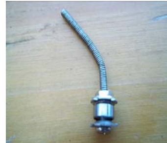
導輪的斷裂，前輪碳纖脫落，導輪螺絲彎成 30 度
