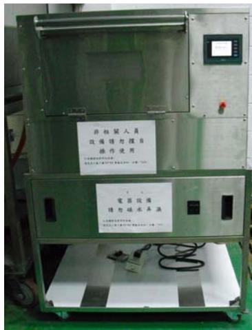
圖 1、機械實體圖：(a)家用過熱蒸氣烤箱，(b)商業型微波過熱蒸氣烤箱
