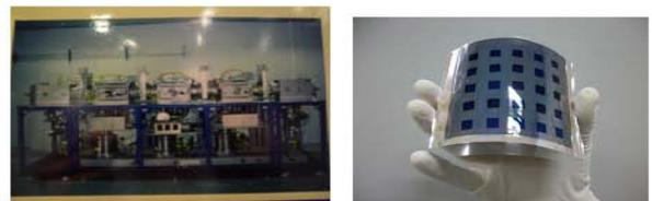
圖 28、太陽能電池鍍製在可撓性聚酰亞胺(PI)基板之研究
