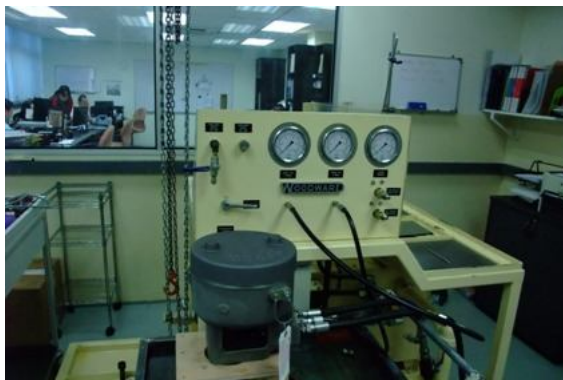
圖九 PM Control 公司 Actuator 維修情形與檢測設備
