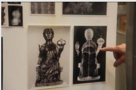
運用 X 光攝影，檢測文物內部結構狀態
