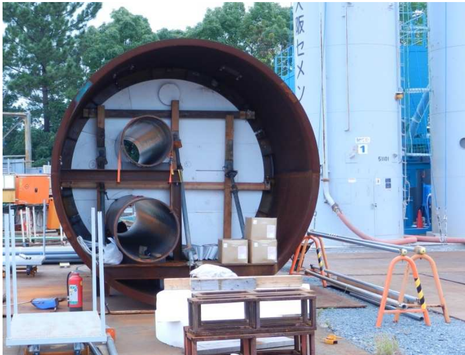
圖 11 洞道斷面模型：洞道內完工後分段全面回填混凝土，模型中亦組立模板支撐，供推力試驗用，以確認足以抵抗灌漿壓力。
